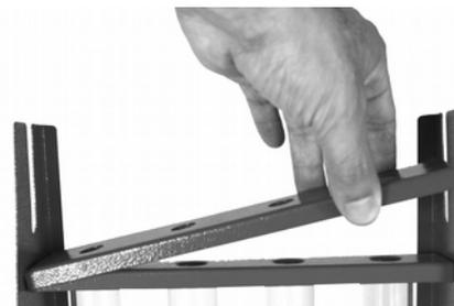
**Adaptador Blaser/S10.** Parafusar o suporte dos injetores (aranha) do próprio automóvel no adaptador e montar sobre as provetas. Os injetores devem estar instalados na aranha. Como são 6 injetores, realizar todos os testes em 4, e posteriormente realizar nos outros dois restantes.
